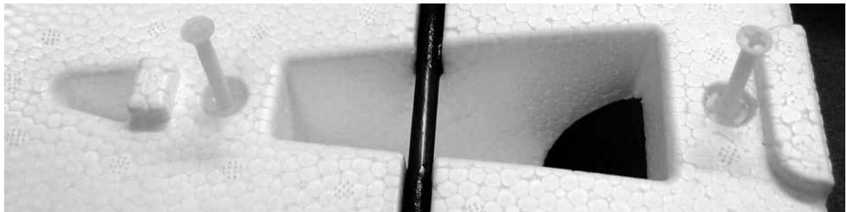
Das CFK-Rohr (22) gemeinsam mit den Teilen (23) einkleben. Insbesondere zum Einkleben der Inserts (19) ausreichend Klebstoff verwenden.
