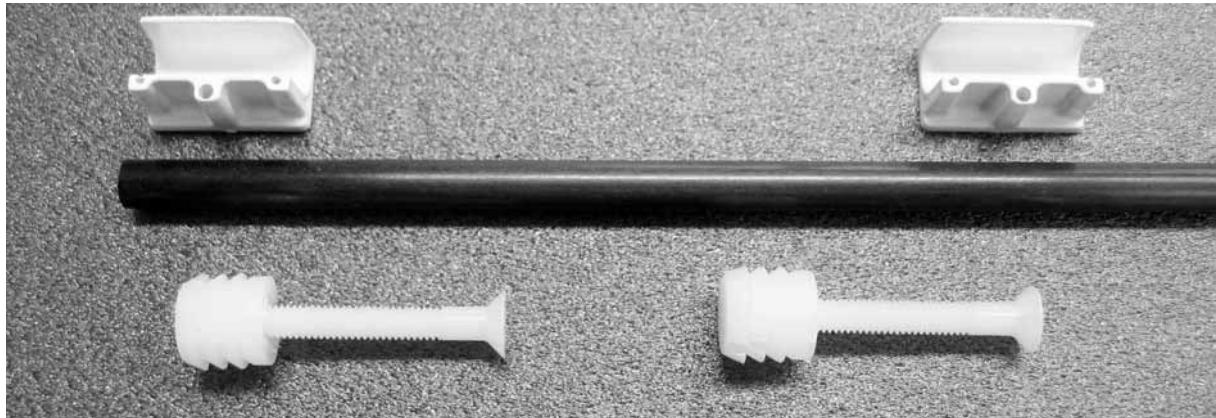
Die Abbildung zeigt die vorbereiteten Einzelteile (19) bis (23) zum Einkleben in die Tragfläche (21). Das CFK-Rohr (22) ist mit Schleifpapier überschliffen und vom Schleifstaub befreit. Zum Einkleben der Inserts (19) die Schrauben (20) eindrehen, somit kann die senkrechte, bzw. geradlinige Lage der Inserts geprüft werden.
