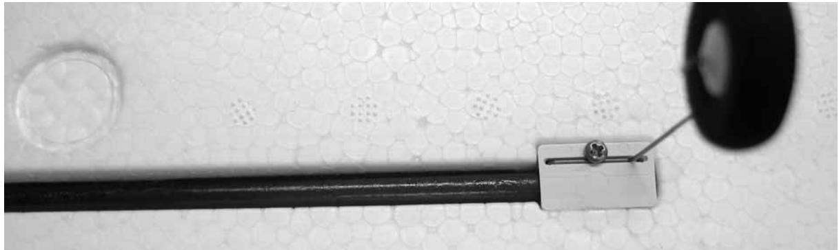
Die Abbildung zeigt den eingeschobenen Fahrwerksbügel, der mit der Blechschaube (25) gesichert ist.
