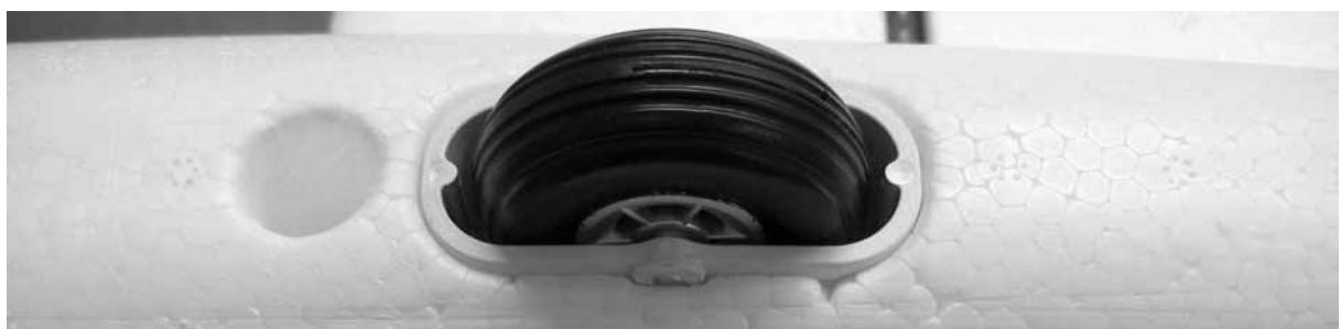
Die komplette Hauptradeinheit in den Rumpf einkleben, darauf achten, dass kein Klebstoff in das Radlager gelangt..
