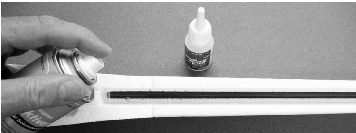
Das CFK-Rohr (2) einkleben, achten Sie darauf, dass die Rumpfunterseite gerade aufliegt.
