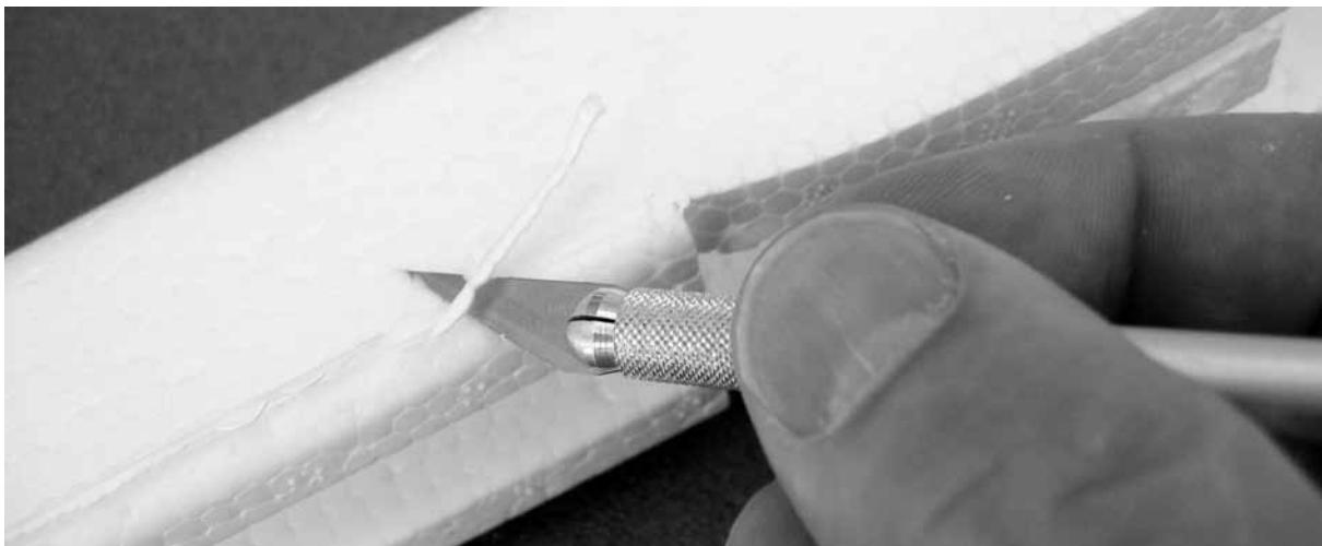
Der Fertigungsgrat am Rumpf (1) wird abgetrennt. Verwenden Sie hierfür eine scharfe Messerklinge.
