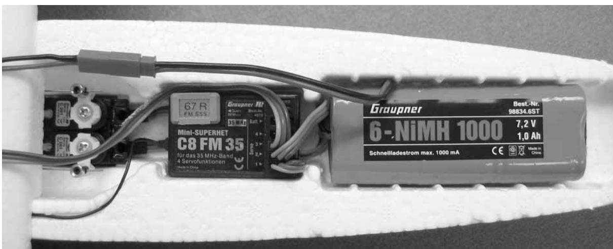
Die Abbildung zeigt die fertig installierte RC-Empfangsanlage mit NiMH-Batterie. Achtung: Die Empfängerbuchsenbelegung weicht von der Bedienungsanleitung der X-306 Fernsteuerung (enthalten bei Best.-Nr. 9400.200) ab, da diese Anleitung in
