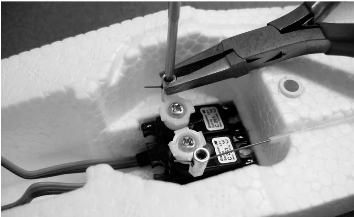
Die Abbildung zeigt die fertig eingeklebten Servos. Die Ruderzüge (16) und (17) führen durch die Gestängeaufnahmen (13) und sind per Seitenschneider abgelängt.
