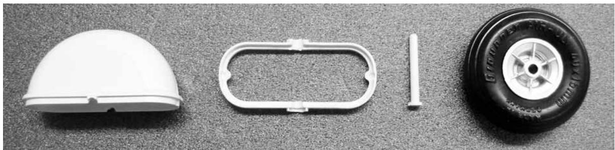
Die Abbildung zeigt die Einzelteile (27 bis 30) des Hauptfahrwerkes. Zuerst die Radaufnahme (28) unter den Radkasten (27) kleben, dann die Einheit mit Radachse (29) und Hauptrad (30) komplettieren.
