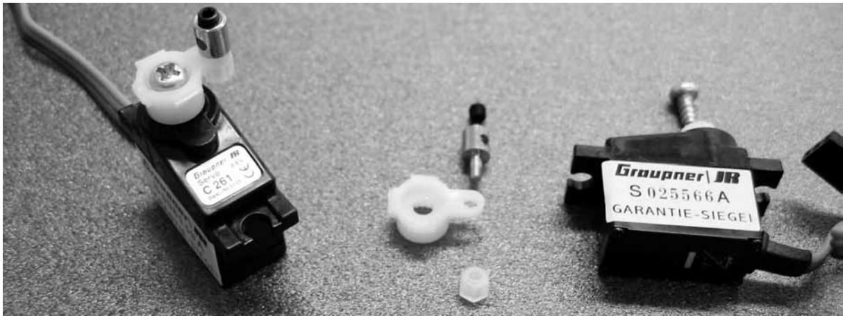
Die Gestängeaufnahmen (13) mittels STOP-Mutter (14) aufschrauben. Achtung, STOP-Mutter nur soweit aufdrehen, dass sich die Gestängeaufnahme gerade noch leicht drehen lässt.
