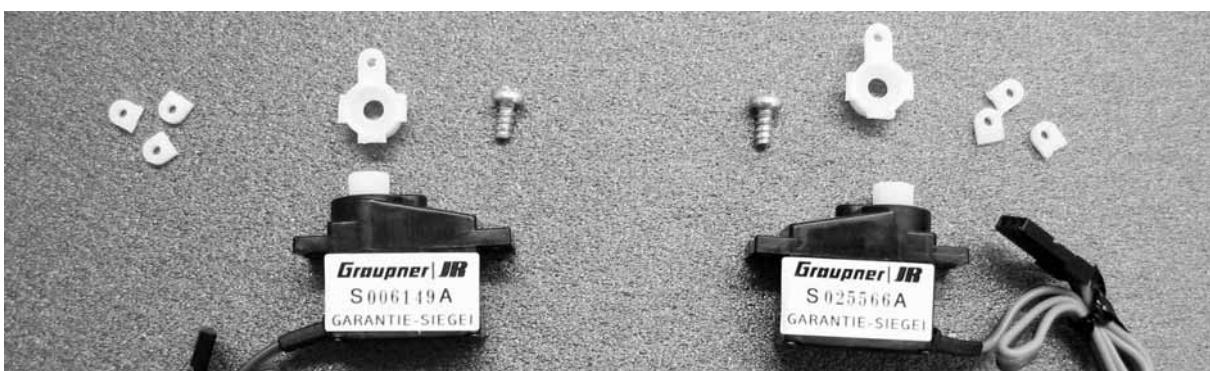
Die Servohebel abschrauben, überflüssige Schenkel mit dem Seitenschneider abtrennen. Die Bohrung der Servohebel für die Gestängeaufnahmen (13) mit einem Bohrer Ø 2,1mm aufbohren. Tipp: Sofern kein passender Bohrer zur Verfügung steht kann das Loch mit der Spitze des Balsamessers jeweils von beiden Seiten passend vergrößert werden. Das Balsamesser wird dann sozusagen als konische Reibahle verwendet.
